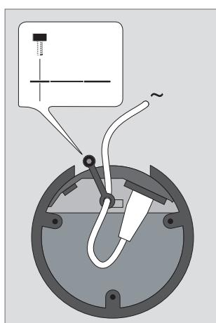
**Кабельный зажим:** По соображениям безопасности сетевой кабель должен быть закреплен на каждой акустической колонке кабельным зажимом, входящим в комплект поставки.
