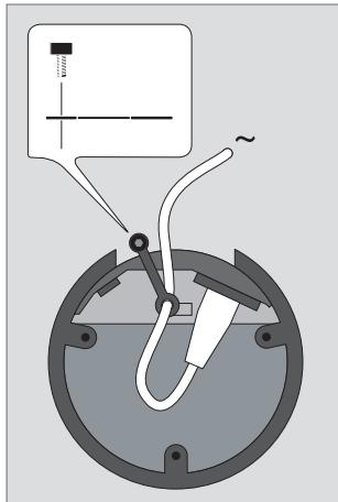
**Collier de serrage :** Pour des raisons de sécurité, le cordon secteur doit être fixé à chaque enceinte à l'aide du collier de serrage fourni.
