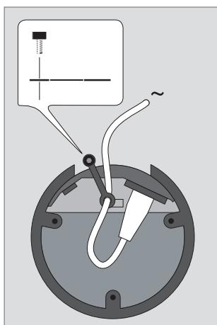
**Fermacavo:** per motivi di sicurezza, è necessario fissare il cavo dell'alimentazione a ciascun diffusore con il fermacavo in dotazione.
