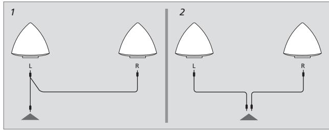
Si conecta los altavoces, por ejemplo, a un sistema de audio o video que no sea Bang & Olufsen con conexiones independientes para los canales de sonido izquierdo y derecho, realice las conexiones como se muestra en la fig. 2.
