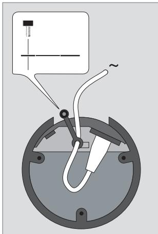
**線纜夾:** 安全起見，每個揚聲器的電源線必須用隨附的線纜夾固定。
