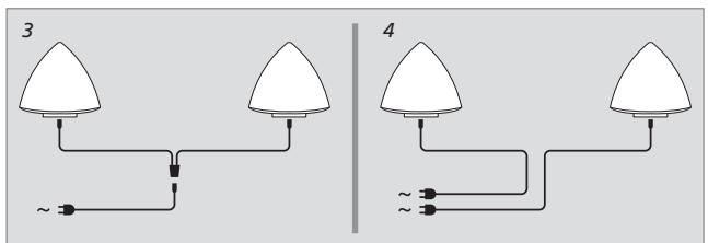
**Σύνδεση ρεύματος:** Ανάλογα με τον τύπο του συνδετήρα ρεύματος που περιλαμβάνεται στη συσκευασία μαζί με τα ηχεία σας, συνδέστε κάθε ηχείο στο ρεύμα όπως απεικονίζεται στην εικ. 3 ή την εικ. 4.
