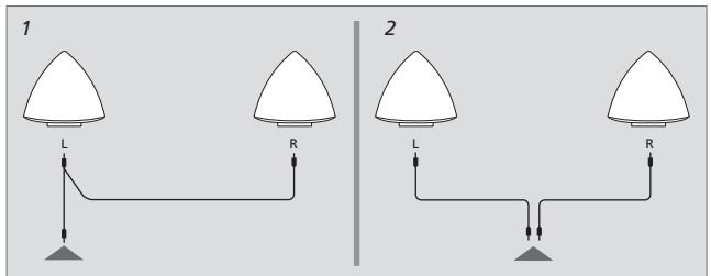
Εάν συνδέετε τα ηχεία, για παράδειγμα, σε σύστημα ήχου ή εικόνας άλλου κατασκευούτη εκτός της Bang & Olufsen με ξεχωριστές συνδέσεις για το αριστερό και το δεξιό κανάλι ήχου, πραγματοποιήστε τις συνδέσεις όπως απεικονίζονται στην εικ. 2.
