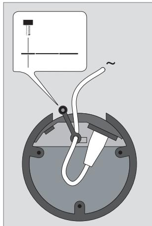
**Kabelklämma:** Av säkerhetsskäl måste elsladden till varje högtalare fästas med kabelklämman som medföljer.
