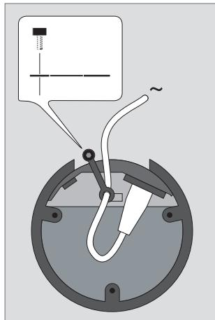
**Kabelholder:** *Af sikkerhedsmæssige årsager skal netledningen til hver højttaler fastgøres med den leverede kabelholder.*
