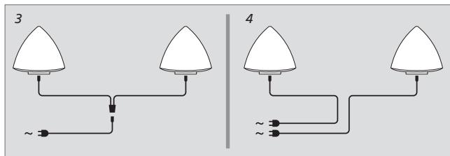
**Conexiones de la alimentación de red:** Dependiendo del tipo de conector de alimentación de red que se adjunte con los altavoces, conecte cada altavoz a la red como se muestra o bien en la fig. 3 o en la fig. 4.
