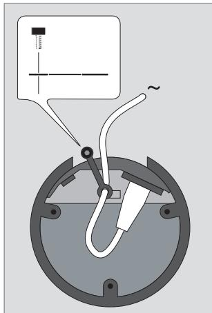
**Άγκιστρο καλωδίων:** Για λόγους ασφαλείας, το καλώδιο ρεύματος σε κάθε ηχείο πρέπει να στερεωθεί χρησιμοποιώντας το άγκιστρο καλωδίων που παρέχεται.
