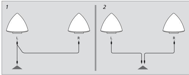
Wenn Sie die Lautsprecher z.B. an ein Audio- bzw. Videosystem mit separaten Anschläüssen für die linken und rechten Tonkanäle anschließen, gehen Sie wie in Abb. 2 vor.
