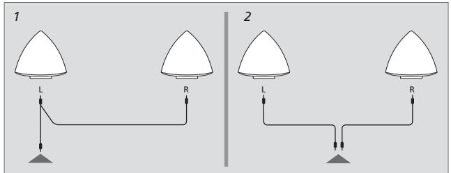
Si vous connectez par exemple les enceintes à un système audiovisuel non fabriqué par Bang & Olufsen et qui dispose de connexions distinctes pour les canaux audio gauche et droit, effectuez les branchements comme le montre la fig. 2.
