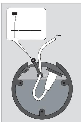
**ケーブルクランプ:** 安全のため、各スピーカーの電源ケーブルは、必ず付属のケーブルクランプで固定してください。
