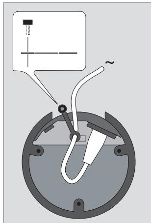
**Abrazadera para cables:** Por motivos de seguridad, el cable de alimentación debe fijarse al altavoz con la abrazadera para cables que se adjunta.
