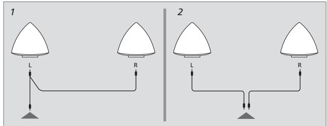
*Hvis du tilslutter højttalerne til et lyd- eller videosystem, som ikke er fra Bang & Olusen, med separate tilslutninger til venstre og højre lydkanal, skal du forbinde enhederne som vist i fig. 2.*
