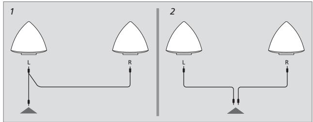
Als u de luidsprekers echter aansluit op bijvoorbeeld een audio- of videosysteem van een ander merk dan Bang & Olufsen met afzonderlijke aansluitingen voor het linker- en rechterkanaal, sluit dan aan zoals weergegeven in fig. 2.
