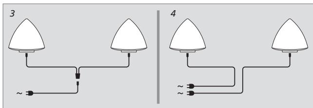
**Netzanschluss:** Schließen Sie jeden Lautsprecher je nach mitgeliefertem Netzadapter wie in Abb. 2 oder Abb. 4 an das Stromnetz an.
