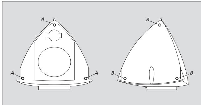
*Der Lautsprecher muss aufrecht auf seinem Boden platziert bzw. an einem optionalen Zubehör befestigt werden. Schließen Sie die Kabel an und stellen Sie den Schalter ein, bevor Sie den Lautsprecher am entsprechenden Zubehör befestigen.*
